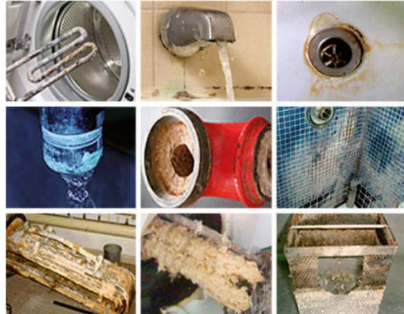
O cálcio e o magnésio dissolvidos na água se cristalizam de forma desordenada e estes cristais se aderem um ao outro e às superfícies de contato, produzindo de imediato, crostas firmes e sólidas que tem um efeito danoso no fluxo da água, com mostra a figura.
