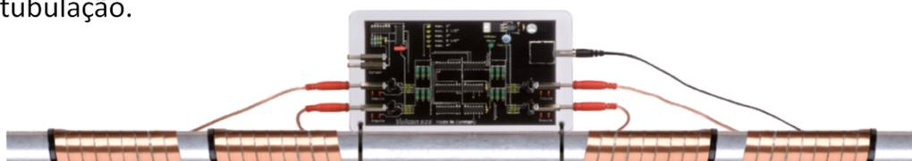
VULCAN trata a água com impulsos elétricos que são gerados na unidade eletrônica e controlados por um microchip computadorizado. A frequência do sinal é transmitida através das fitas de impulso que são enroladas em torno dos tubos. As fitas interagem aos pares e formam um campo de frequência que trata a água que passa no tubo.
